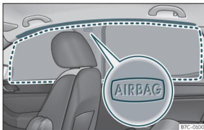
Fig. 21 Posizione degli airbag per la testa.
