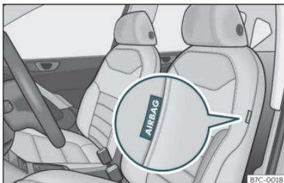
Fig. 19 Airbag laterale all'interno del sedile del conducente.
