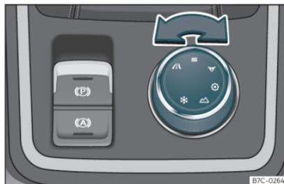
Fig. 146 Console centrale: Manopola di comando (Driving Experience button).
