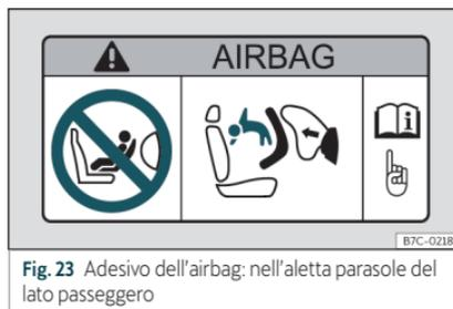
**Fig. 23** Adesivo dell'airbag: nell'aletta parasole del lato passeggero
