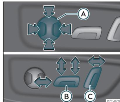
Fig. 102 Sedile del conducente: regolazione elettrica del sedile.
