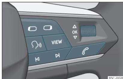
**Fig. 62** Lato destro del volante multifunzione: tasti per l'utilizzo dei menu e delle indicazioni informative del quadro strumenti.
