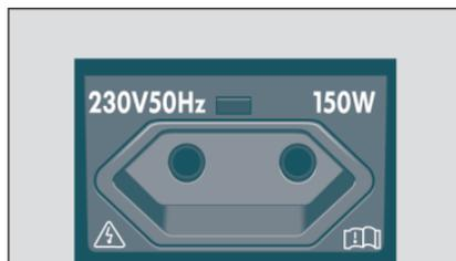
Fig. 128 Sul lato sinistro del bagagliaio: presa elettrica da 230 Volt.
