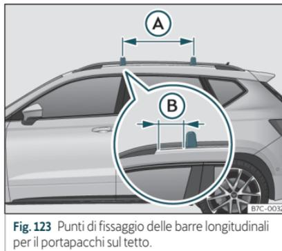
Fig. 123 Punti di fissaggio delle barre longitudinali per il portapacchi sul tetto.
