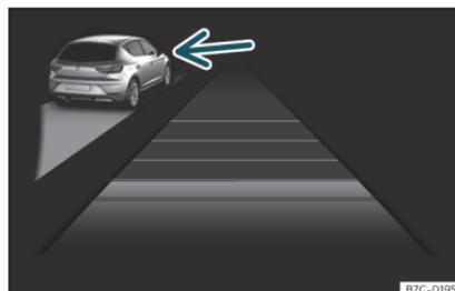
Fig. 163 Sul display del quadro strumenti: ACC attivo, veicolo rilevato sulla sinistra
