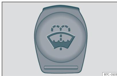
Fig. 207 Nel vano motore: tappo del serbatoio del tergicristalli.
