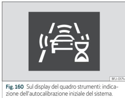
**Fig. 160** Sul display del quadro strumenti: indicazione dell'autocalibrazione iniziale del sistema.
