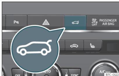
**Fig. 84** Console centrale: tasto per aprire e chiudere il portellone posteriore.
