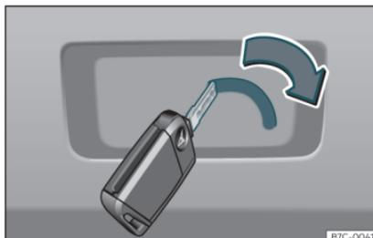
Fig. 87 Particolare del bagagliaio: sblocco di emergenza.
