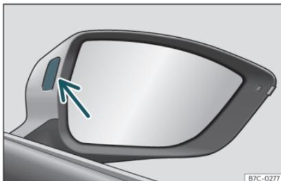
**Fig. 171** Spia di controllo assistente al cambio corsia.
