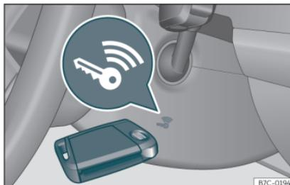
**Fig. 140** A destra del piantone dello sterzo: avviamento di emergenza.
