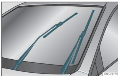
Fig. 37 Tergicristalli in posizione di manutenzione.
