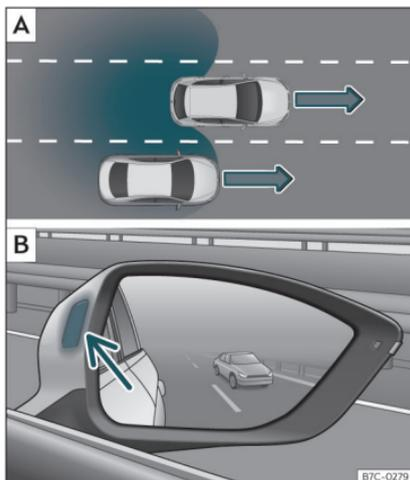
**Fig. 173** Rappresentazione schematica: **A** Situazione in un sorpasso e incorporamento successivo alla corsia destra. **B** Indicazione dell'assistente al cambio corsia sullo specchietto retrovisore esterno destro.
