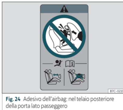
**Fig. 24** Adesivo dell'airbag: nel telaio posteriore della porta lato passeggero
