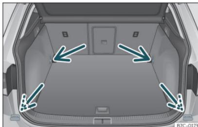
Fig. 116 Nel bagagliaio: occhielli di ancoraggio.
