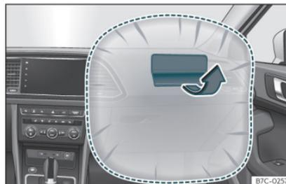
Fig. 14 Airbag del passeggero sul cruscotto.
