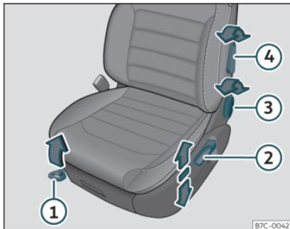
Fig. 101 Sedili anteriori: regolazione manuale del sedile.
