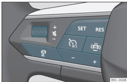
**Fig. 161** Sul volante multifunzione: tasti di comando dell'ACC
