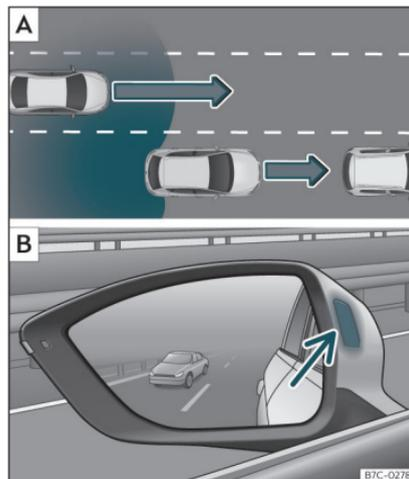
**Fig. 172** Rappresentazione schematica: **A**) Situazione in un sorpasso con traffico sulla parte posteriore. **B**) Indicazione dell'assistente al cambio corsia sullo specchietto retrovisore esterno sinistro.
