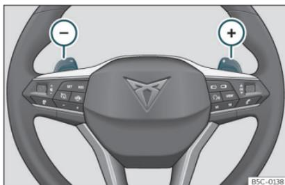
Fig. 144 Volante: leve per il cambio automatico.
