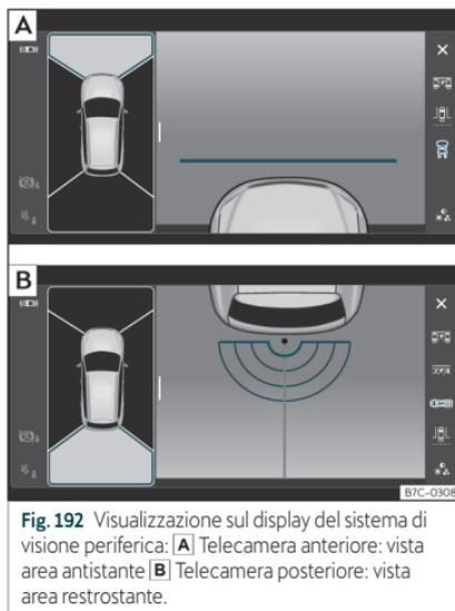
**Fig. 192** Visualizzazione sul display del sistema di visione periferica: **A**) Telecamera anteriore: vista area antistante **B**) Telecamera posteriore: vista area restandante.
