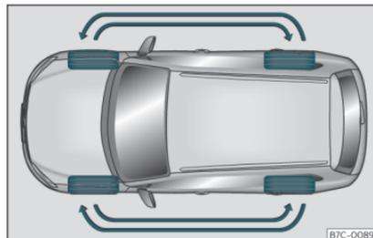
Fig. 211 Scambio delle ruote.
