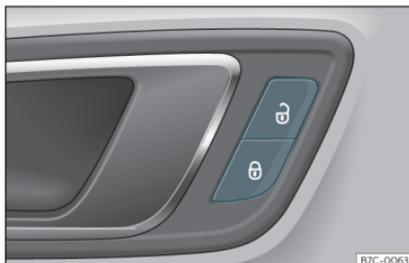
**Fig. 75** Porta del conducente: interruttore della chiusura centralizzata.
