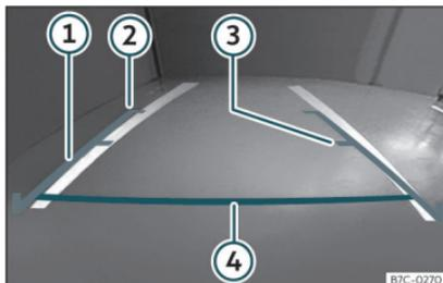
Fig. 193 Display del sistema infotainment: linee di riferimento.
