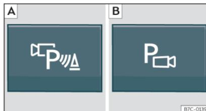
**Fig. 191** Console centrale: tasto per attivare/disattivare manualmente il sistema di visione periferica quando è abbinato all'assistente di parcheggio (**A**) o al sistema Park Pilot posteriore (**B**).
