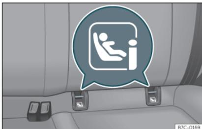
**Fig. 25** Sedile posteriore: occhelli di fissaggio ISOFIX/i-Size.
