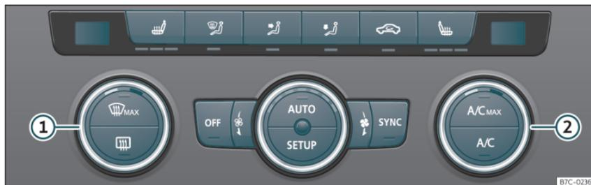
Fig. 129 Sulla console centrale: comandi del Climatronic.
