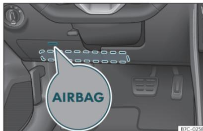
**Fig. 17** Sul lato conducente: posizione dell'airbag per le ginocchia.
