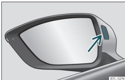
**Fig. 170** Spia di controllo assistente al cambio corsia.
