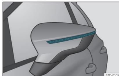
**Fig. 55** Indicatore di direzione integrato nello specchietto retrovisore
