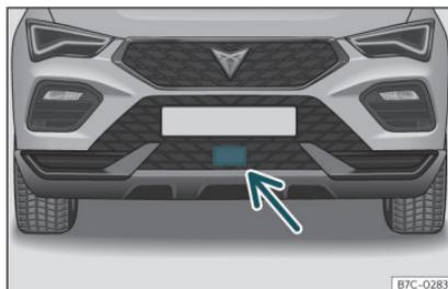
Fig. 148 Sul paraurti anteriore: sensore radar.
