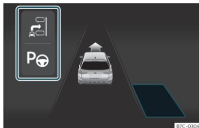
Fig. 178 Sul display del quadro strumenti: visualizzazione dell'assistente di parcheggio con visualizzazione ridotta.
