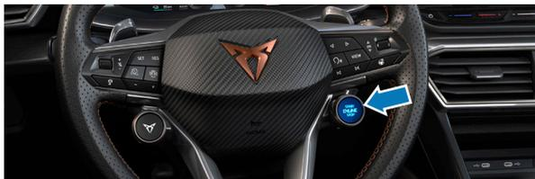
Premere il pulsante START-ENGINE-STOP situato sul piantone dello sterzo senza premere il pedale del freno.
